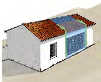
Pose des panneaux composée en harmonie avec la taille et l'axe des ouvertures en façade
